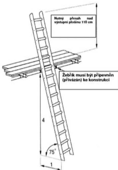
Obr. 7 Ukázka správného umístění žebříku
